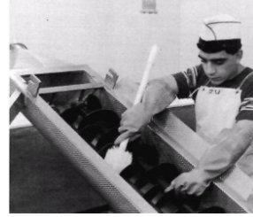
Bir işçi Teflon®-P'nin burguyu, yumuşak bir fırça ve suyla kolaylıkla temizliyor.
