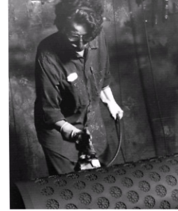
Uygulayıcı, pirinçten kurabiye kalıbı silindirini Teflon® ile kaplıyor.
