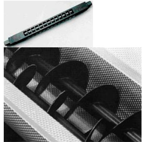
Bu burgulu aletin üzerindeki Teflon®-P kaplaması, işlem esnasında peynirin yüzeye yapışmasını engeller.
