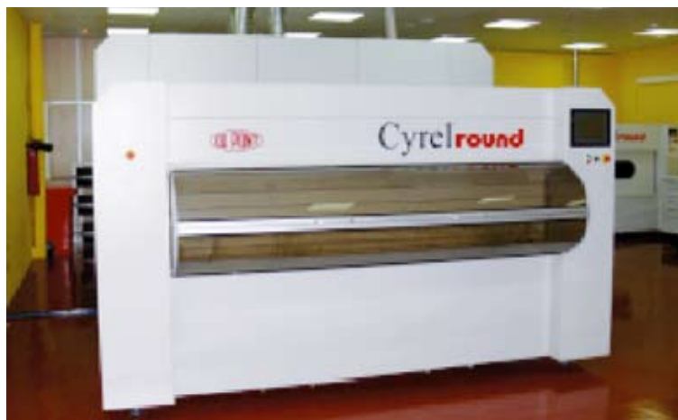
Die jüngste Investition von Diflex: Eine Cyrel® round-Lösung zur Herstellung nahtloser Sleeves für einen Verpackungsdruck von hoher Präzision und Qualität
