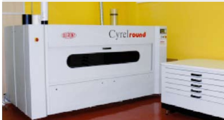
Die jüngste Investition von Diflex: Eine Cyrel® round-Lösung zur Herstellung nahtloser Sleeves für einen Verpackungsdruck von hoher Präzision und Qualität
