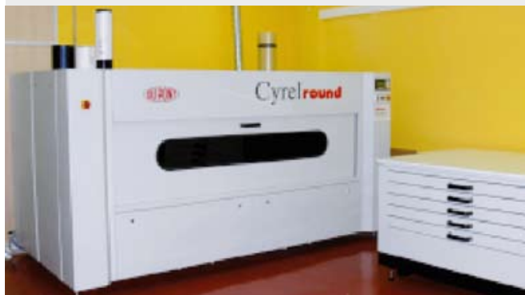
Le tout dernier investissement de Diflex : Le système Cyrel® round produit des manchons continus pour une impression précise et de grande qualité des emballages
