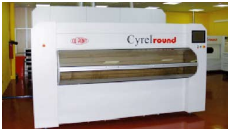
Le tout dernier investissement de Diflex : Le système Cyrel® round produit des manchons continus pour une impression précise et de grande qualité des emballages
