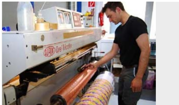
Endgültiger „Testlauf“ beim Hersteller: Einzelne Klischees werden auf dieser Rundmontage- und Andruckmaschine von DuPont zu kompletten Druckformen zusammen gestellt.
