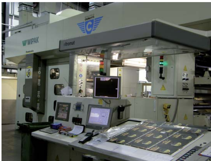
Wipak's neueste Druckmaschine, die Flexotecnica, welche Cyrel® round und das Registrier-System Eltromat automatic für schnellste herausragende Passergenauigkeit verwendet.
