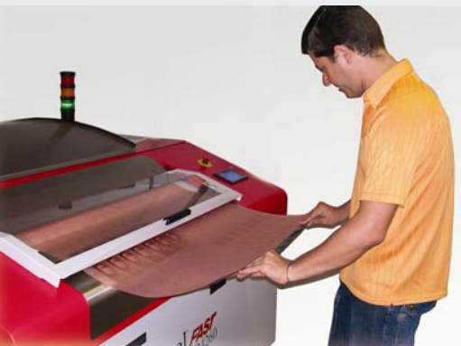
Equipo Cyrel Fast TD 4260: equipamiento responsable por la revelación térmica del fotopolímero sin utilización de productos químicos.
