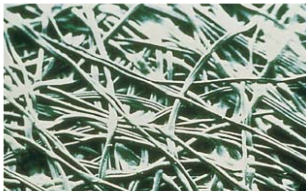
Figure 2 : Vue microscopique de DuPont™ Typar®.
